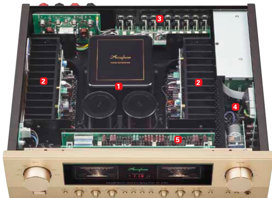
▲ Immer schön anzusehen: Der gewohnte Anblick eines Accuphase-Vollverstärkers mit zentralem Netzteil (1), den Endstufeneinheiten (2) sowie dem Eingangs- (3), Vorstufen- (4) und Kontrollsektor (5).
