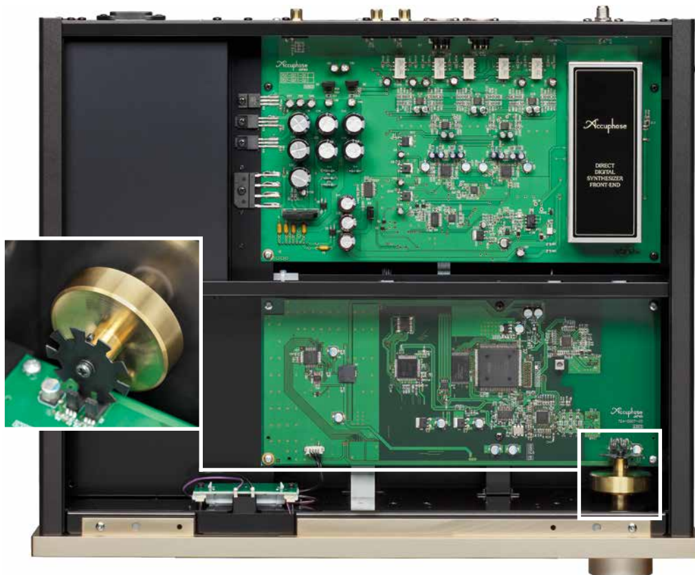
Bei abgenommenem Deckel erscheint der Accuphase-typische aufgeräumte Aufbau mit gekapselter Netzteil- (l.) und Frontend-Sektion (r.o.). Hinter dem Abstimmknopf steckt ein Impulsgeber (s. Rahmen).
