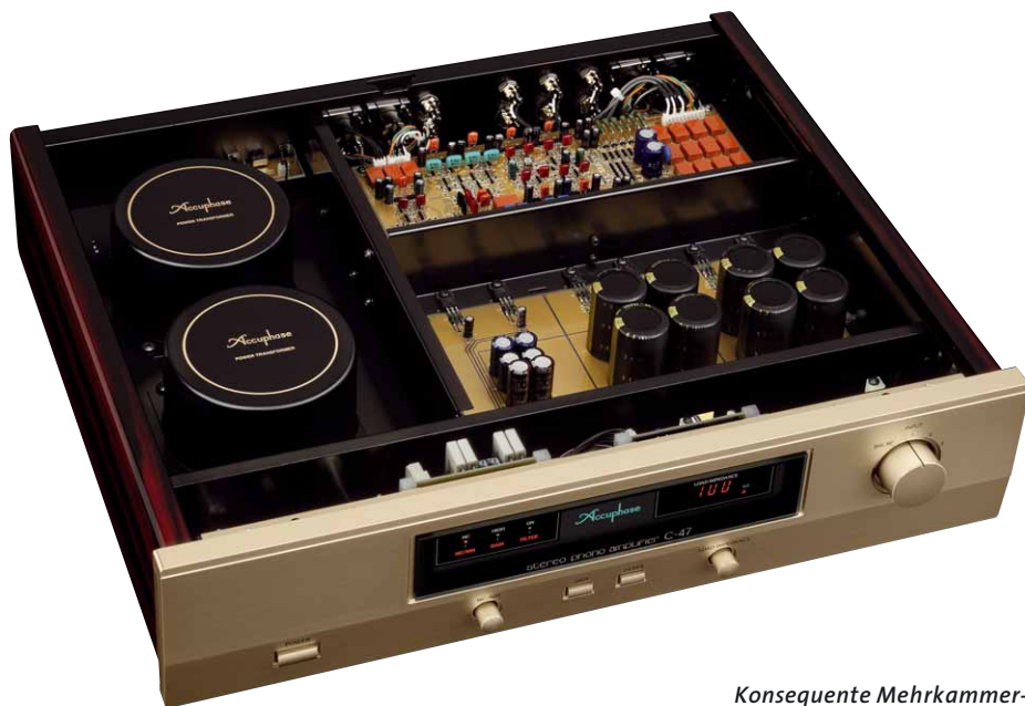
Konsequente Mehrkammerbauweise: Die C-47 verteilt sich auf vier Abteilungen
