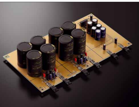
Die Netzteilplatine generiert mit diskreten Regelschaltungen die Betriebsspannungen für die Verstärkerplatine
