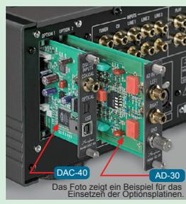
Das Foto zeigt ein Beispiel für das Einsetzen der Optionsplatten.
