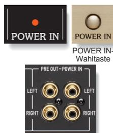
Vorverstärker-Ausgänge (links) Leistungverstärker-Eingänge (rechts)
