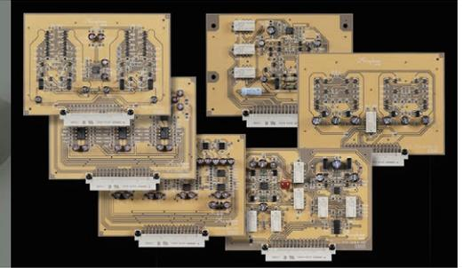
Leiterplatten aus GFK mit Fluorkarbonharz mit niedriger Dielektrizitätskonstante und geringem Verlustfaktor, sowie vergoldeter Leiterbahnseite
