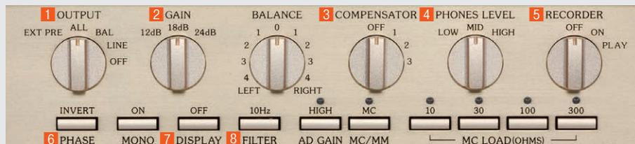
Zusatzbedienfeld 1 Ausgangswähler 2 Verstärkungsfaktor-Wähler 3 Loudness-Kompensationswähler 4 Kopfhörer-Pegelwähler 5 Recorder-Wähler 6 Phasenwahltaste 7 Anzeige-Ein/Aus-Taste 8 Rumpelfilter
