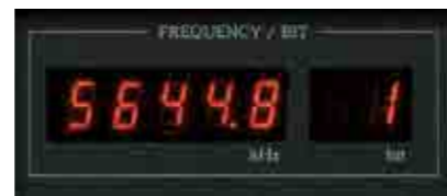
▲ Bis zu 384 Kilohertz Abtastfrequenz bei 32 Bit kann man dem Accuphase ins Display zaubern. Beim „1-Bit-Format“ der DSD sind 5,6 Megahertz Bandbreite drin (u.).
