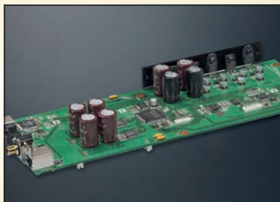
AUSRECHNEN: Digitalbord mit Spannungsversorgung, Wandlern etc.
