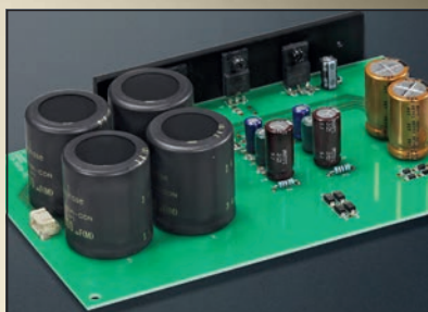
VERSORGEN: Stromversorgungsplatine mit vier Sieb-Elkos à 15000 µF.
