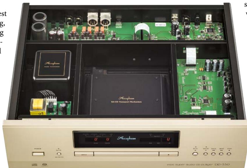
Der für Accuphase typische saubere, geordnete Aufbau mit zentralem Laufwerk. Das kleine Netzteil vorne links dient nur dem „Eco-Mode“
