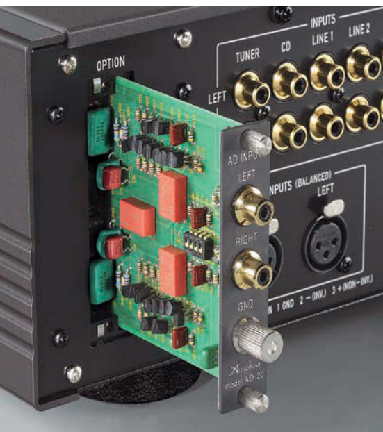
Das „Option“-Terminal lässt sich mit einem Phono- (Foto), D/A-Wandler- oder einem unsymmetrischen (Cinch) Eingangsmodule bestücken
