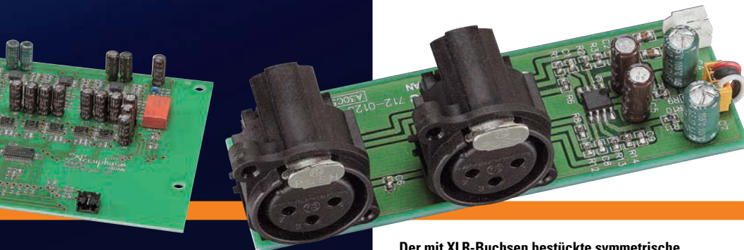
Der mit XLR-Buchsen bestückte symmetrische Eingang sitzt inklusive eines Operationsverstärker-Chips auf einer eigenen Platine
