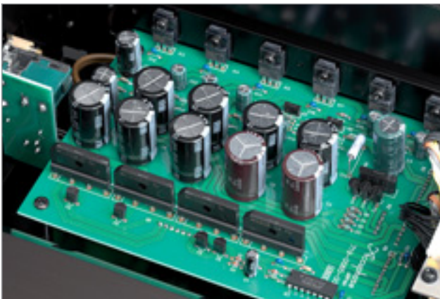
Mehrere, ab Netztrafo voneinander unabhängige Stromversorgungen legen den Grundstein für guten Klang
