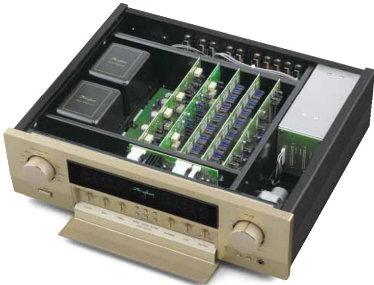
Vorverstärker C 2110: Die Elektronik in der vorderen Abschirmsection steuert die neuartige Pegelregelung, deren Bauteile auf zwei der Platinen in der Mitte sitzen. Der rechte und linke Kanal bleiben stets strikt getrennt, jede Seite bekam sogar einen eigenen Netztrafo.
