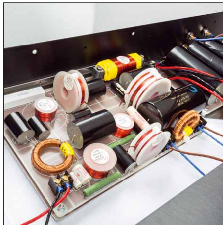
Die Filterung geriet für ein Zweiwegsystem ziemlich aufwendig
