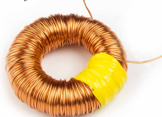
Die Ringkern-Luftspulen sind besonders einstrahlensicher und Made By YG Acoustics
