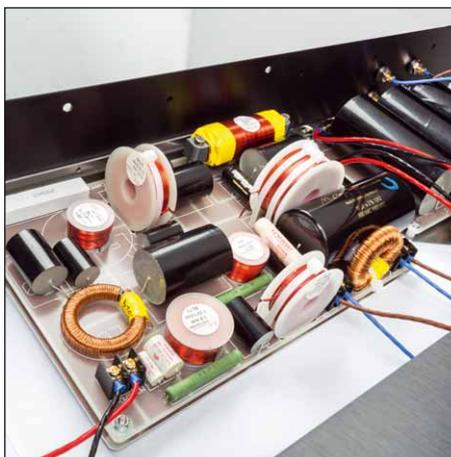
*Die Filterung geriet für ein Zweiwegensystem ziemlich aufwendig*
