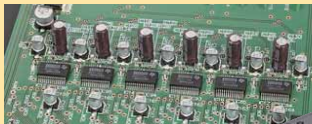
Im DP-510 arbeiten gleich sechs Wandler-Chips von Texas Instruments parallel, was die Fehlerrate um mehr als den Faktor zwei reduzieren soll
