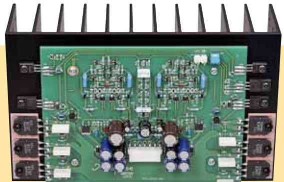
Auf den Kühlkörper ist die komplette Endstufe eines Kanals samt Treibern sowie den hier abweichend vom alten E-450 verwendeten MOS-FET-Leistungshalbleitern montiert
