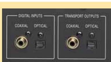
Neben koaxialem und Lichtleiter-Digital-Ausgang besitzt der DP-510 auch ebensolche Inputs, ist also für externe Bit-Lieferanten als hochwertiger DAC nutzbar
