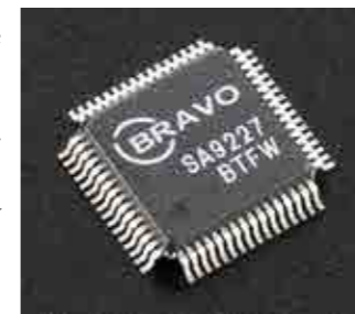
▲ Dieser kleine Vielfüßer organisiert den USB-Eingang des Accuphase für vielfältigste Formate.
