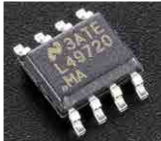
▲ Hochpräzise Operationsverstärker filtern die Signalströme für Cinch und XLR vollkommen separat.
