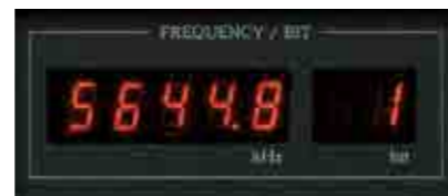
▲ Bis zu 384 Kilohertz Abtastfrequenz bei 32 Bit kann man dem Accuphase ins Display zaubern. Beim „1-Bit-Format“ der DSD sind 5,6 Megahertz Bandbreite drin (u.).
